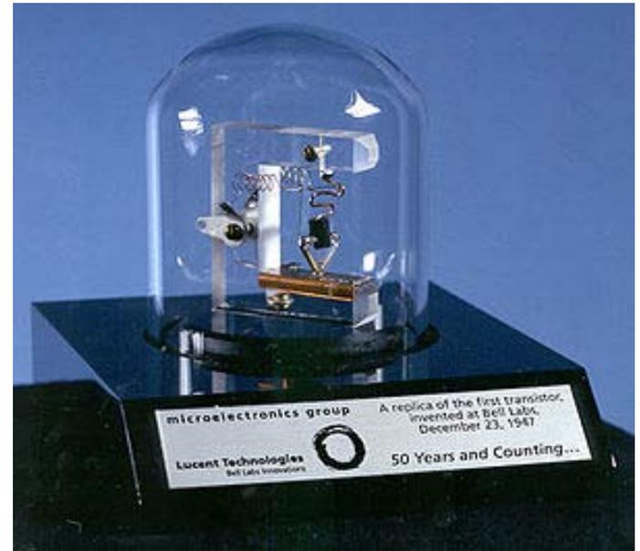
Макет точечного транзистора Бардина и Браттейна. Треугольник в центре — прозрачная призма, по рёбрам которой приклеены полоски фольги — выводы коллектора и эмиттера. Базой служит металлическое основание, на котором закреплён германиевый кристалл
